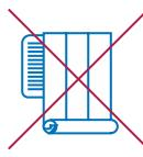
Не закрывайте отверстия дымоходов и вентиляционных каналов.
