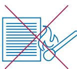
Не проверяйте тягу в дымовом и вентиляционном каналах с помощью огня.
